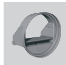
RD BP Reguladores de caudal autorregulables de baja presión. (20/100 PA) Para instalar en el interior del conducto. Diámetro 80 mm. Caudal: 15 ó 30 m³/h.
